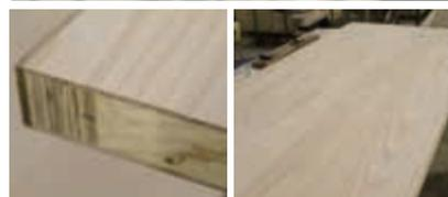
突板を効果的に使って無垢材の質感を出した建具は、框部材を無垢材でつくる一般的な製法とは違い、あえて框に横ハギの集成材を使用。中にはめる板には、反りにくい3層CLTのパネルを使うなど、独自のやり方を実践しています。框のないフラットなタイプのドア『杉モダン』は、そのオリジナル性の高さでスマートなスタイルが30～40代の客層に好評です。
